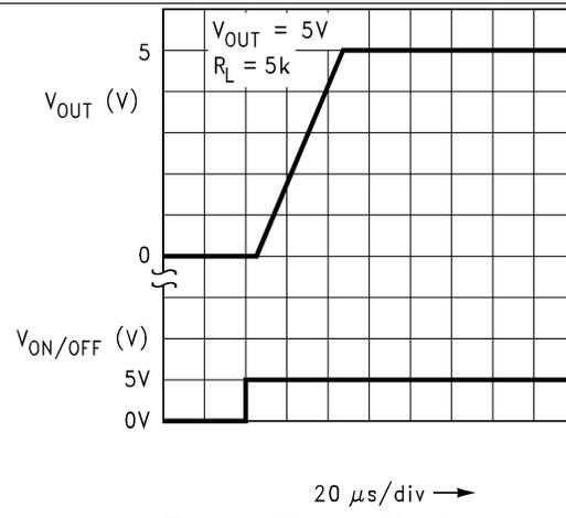
Figure 28. Turn-On Waveform
